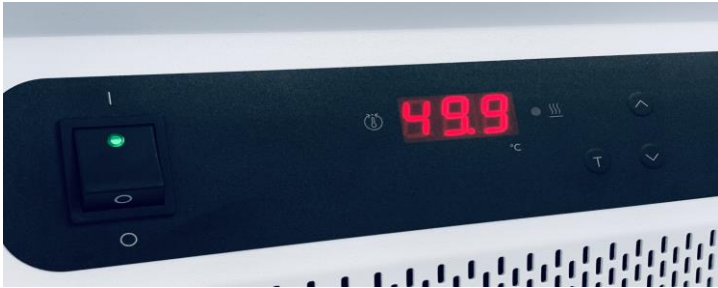
Control panel for setting and display of the temperature H 20 S, H 20 SW und H 20 SOW
